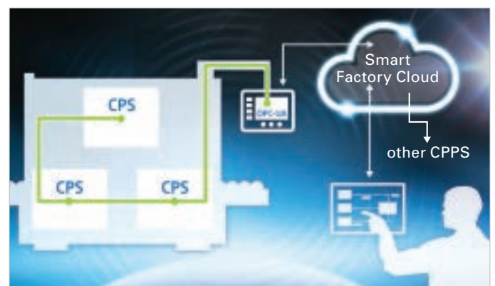
Afbeelding 2: verschillende onafhankelijke cyber-fysieke systemen zijn verticaal verbonden met een cyber-fysiek productiesysteem, dat met de smart factory cloud communiceert.
